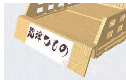
後方にはミラーの取り付けが可能 (t=2mm)
